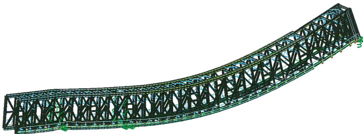
Rys. 4 – Wizualizacja modelu MES – Demontaż podpory tymczasowej PT5
