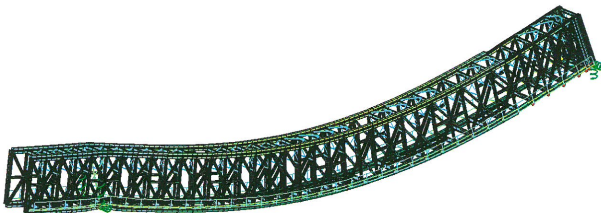
Rys. 5 – Wizualizacja modelu MES – Demontaż podpory tymczasowej PT6
