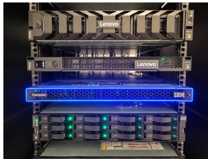
Sprzęt ICT - od góry serwer wirtualizacji, serwer bazodanowy, macierz dyskowa, półka rozszerzeń do macierzy
